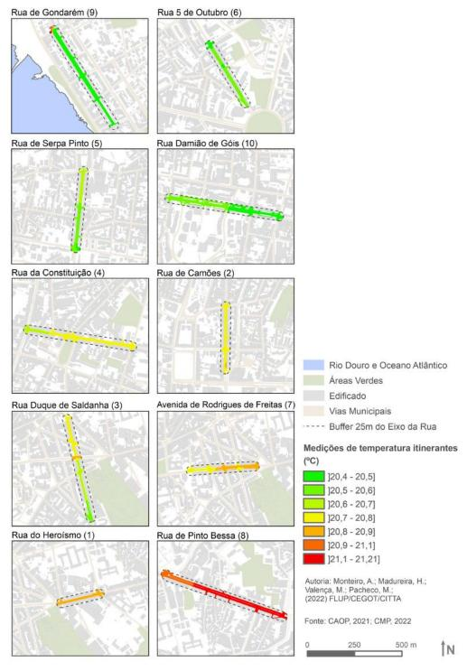
Figura 122 - Medições de temperatura itinerantes ao longo das 10 ruas-protótipo<sup>2</sup>
